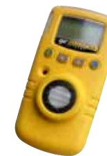
Gassmåler som umiddelbart gir signal ved for høy avdampning av H 2 S gass.
