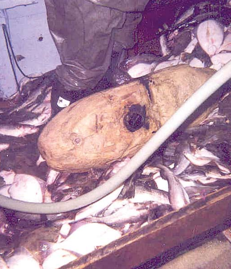
Sennepsgassbombe. Metallet tært bort (Foto Bornholm Marinedistrikt).
