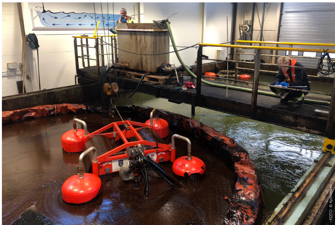
IMAROS-prosjektet: Testing med oljeopptaker i nasjonalt senter for testing av oljevernustyr i Horten.
