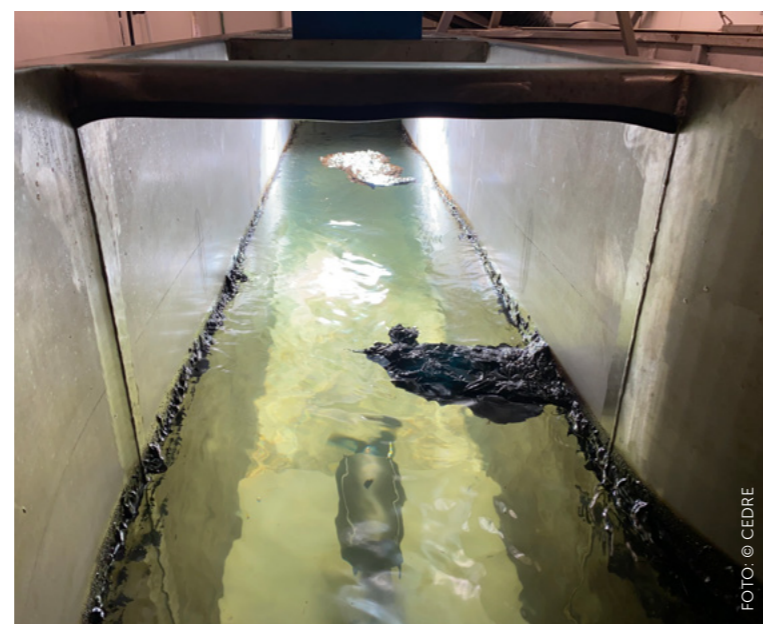
IMAROS-prosjektet: Testolje som har stivnet på overflaten under testing hos samarbeidspartner CEDRE i Brest, Frankrike.
