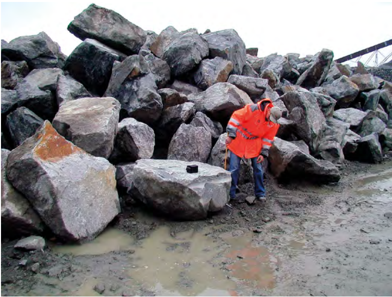
Figur 8-5 Dersom man ikke har utstyr til å veie blokker, kan blokkene måles opp og vekten beregnes. Her vist ved blokker som er godt egnet til plastring. (Stein til Bykaia, Longyearbyen. Foto Norconsult).
