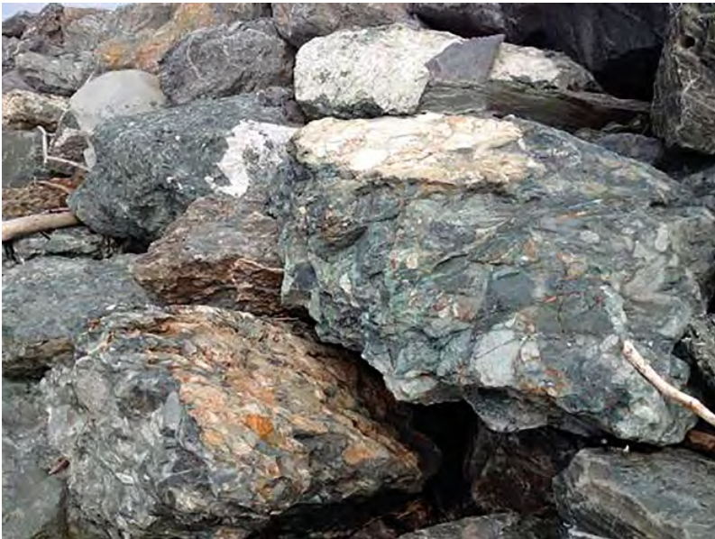
Figur 8-6 Eksempel på blokker som er dårlig egnet til plastring – blokkene er runde uten en tydelig plan side, og de er for korte i forhold til tykkelsen. (Værnes).
