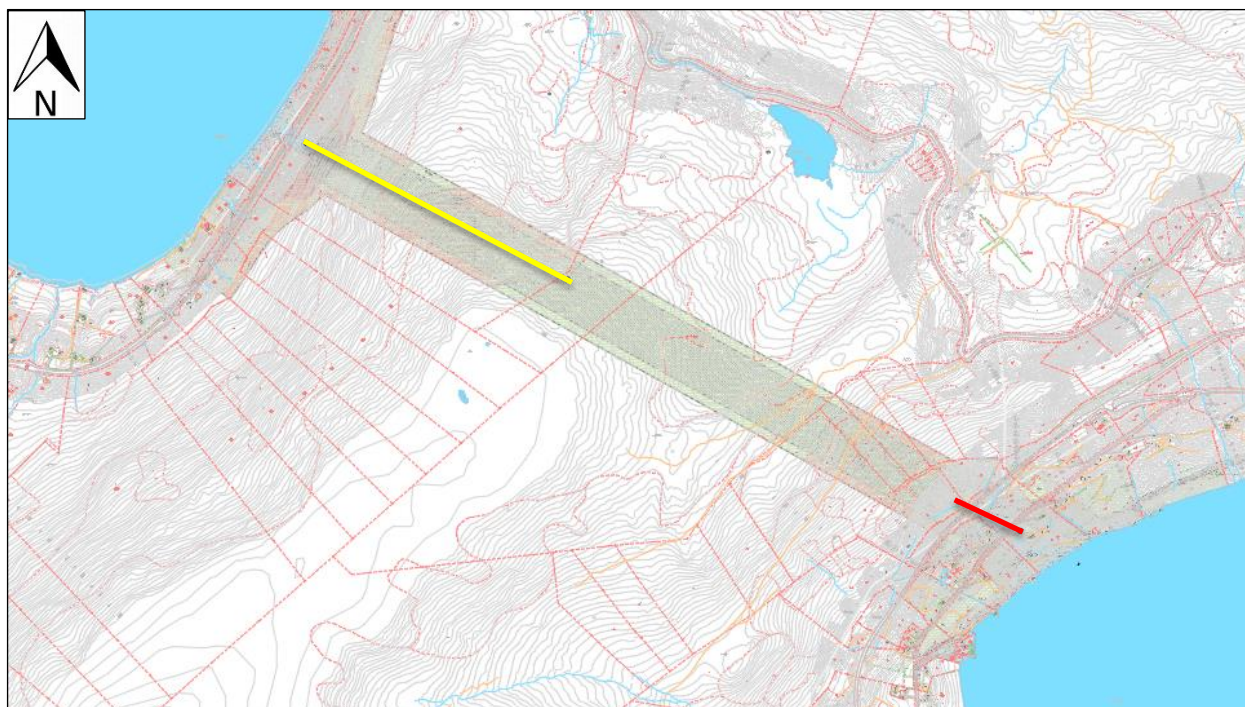
Figur 1-1: Skipstunnelen er planlagt mellom Moldefjorden og Kjøddepollen. Gul linje markerer utført boring fra Moldefjorden. Rød linje markerer utført boring fra Kjøddepollen.
