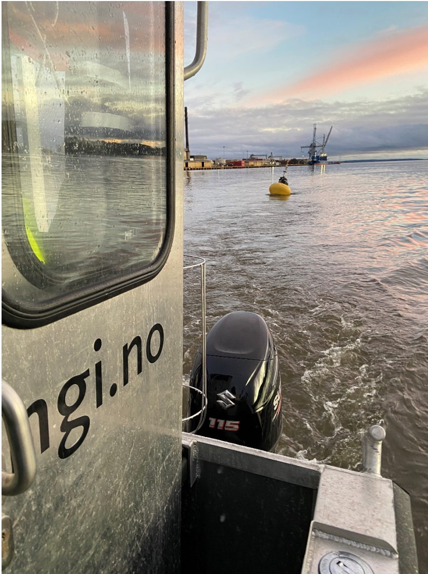
Stasjonær målebøye for kontinuerlig overvåking av turbiditet (partikkelmengde) under prøvemudring. (felt midt, 11.11.)
