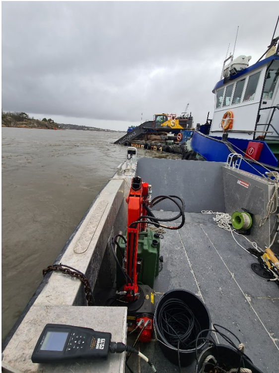
Manuelle målinger av turbiditet (partikkelmengde) fra NGIs forskningsfartøy FF Kolstad (felt midt, 10.11.)
