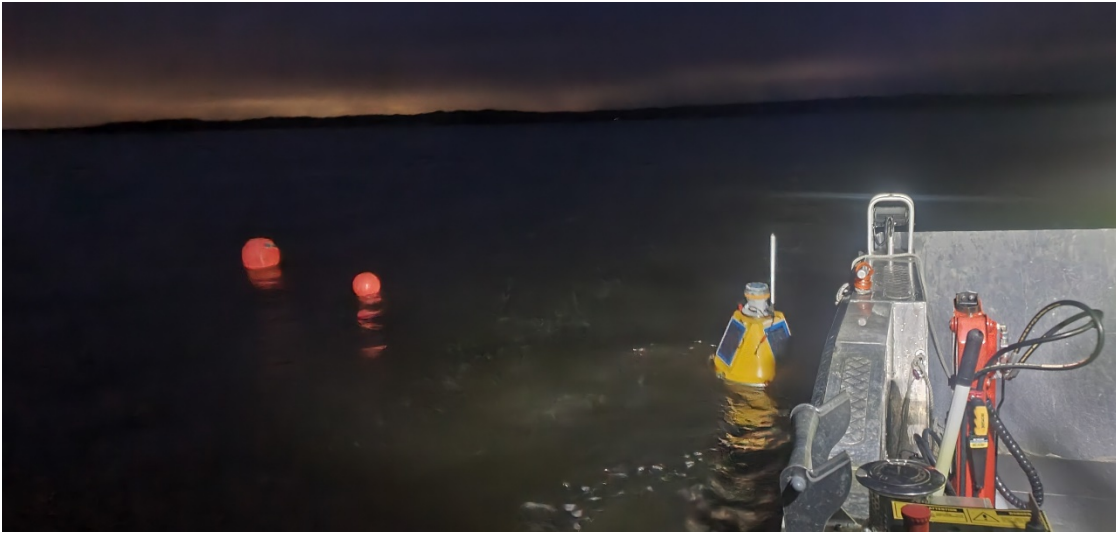
Stasjonær målebøye for kontinuerlig overvåkning av turbiditet (partikkelmengde) under prøvedeponering ved Svaleskjær. (14.11.)
