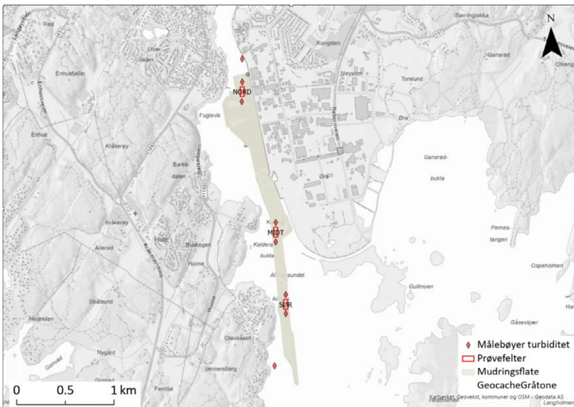
Figur 7 Prøvefelter med plassering av målebøyer for turbiditetsmålinger, samt område for plassering av referansemålestasjoner.
