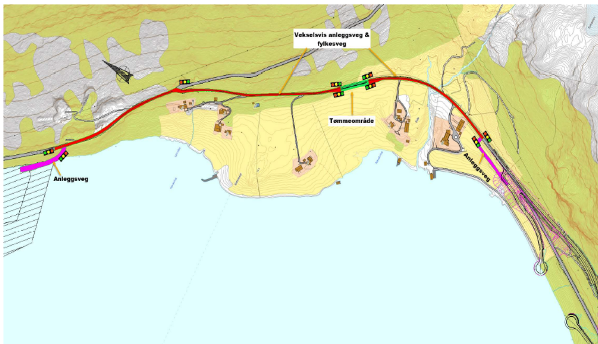
Figur 1. Omsøkte løsning på Moldefjord-siden Fv. 618 med vekselvis lysregulering av dumpere og ordinærtrafikk over en vegstrekning på 1,2 km.
