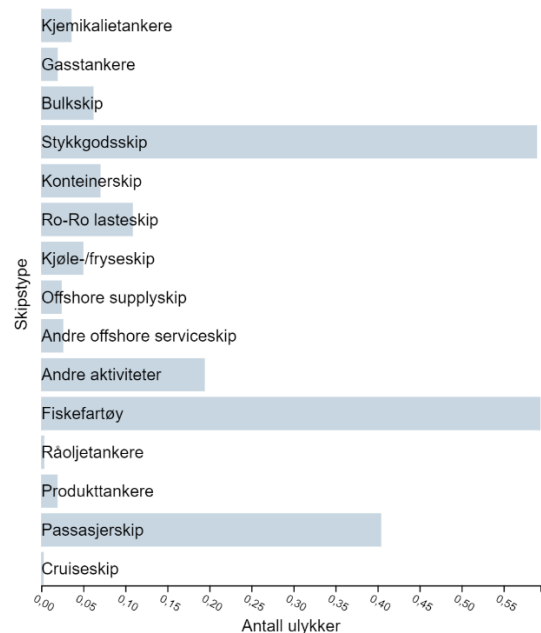
Figur 4-3 Sannsynlighet for ulykker med utslipp av mer enn 0,9 tonn drivstoff i analyseområdet uttrykt i antall ulykker per år i perioden 2015-2021.
