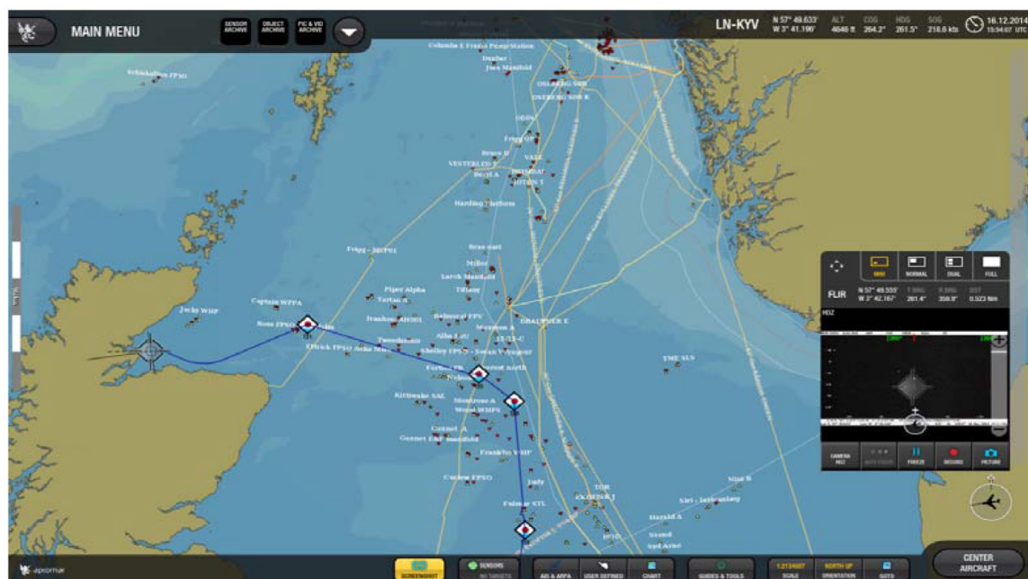
Figur 13: Viser kartdelen av operatorkonsoll om bord i LN-KYV med kart hvor blant annet Offshore kartlag for overflateinstallasjoner, samt subsea innretninger og rørledninger er med.
