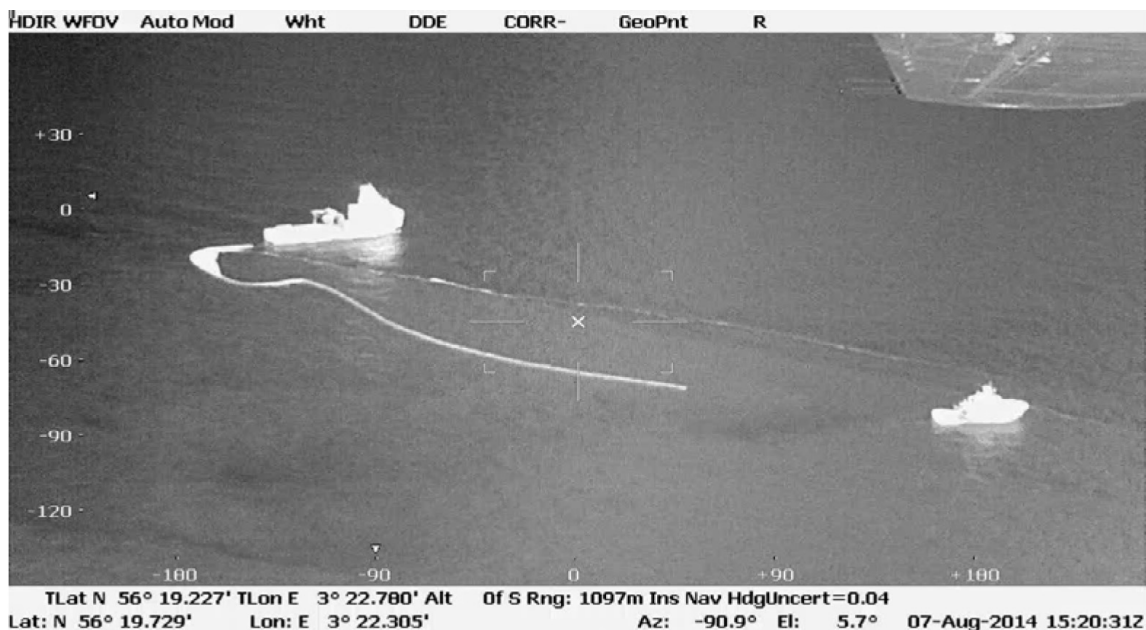
Foto: Fra hendelse ved Eldfisk: Oljevernssystem dirigeres inn i området hvor mesteparten av oljeemulsjonen befinner seg (IR-hvit).
