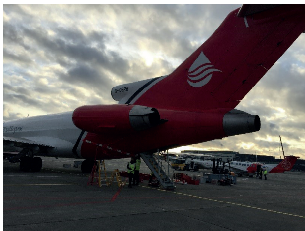
Figur 25. OSRL dispergerings fly og dispergeringsarmer bak under motorer. (Foto: NOFO)
