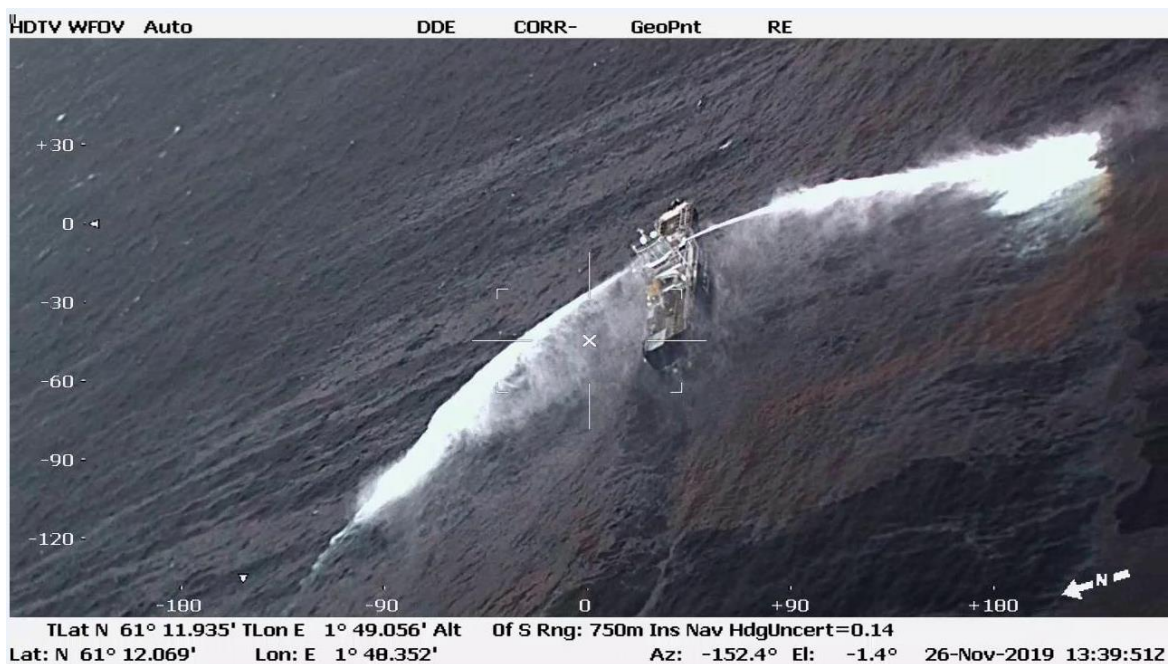
Figur 39. Første bilde fra LN-KYV viser Stril Mercur i gang med mekanisk dispergering ved bruk av brannkanonene.
