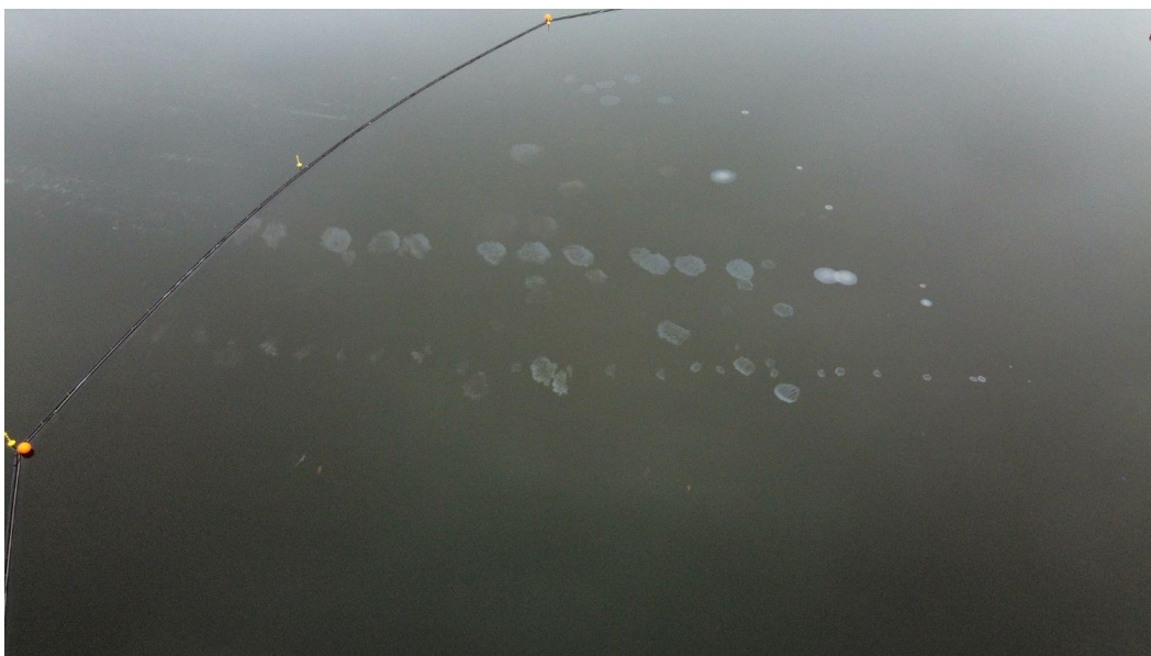
Figur 3-3 Lensesetting rundt olje som kommer opp fra krigsvraket.
