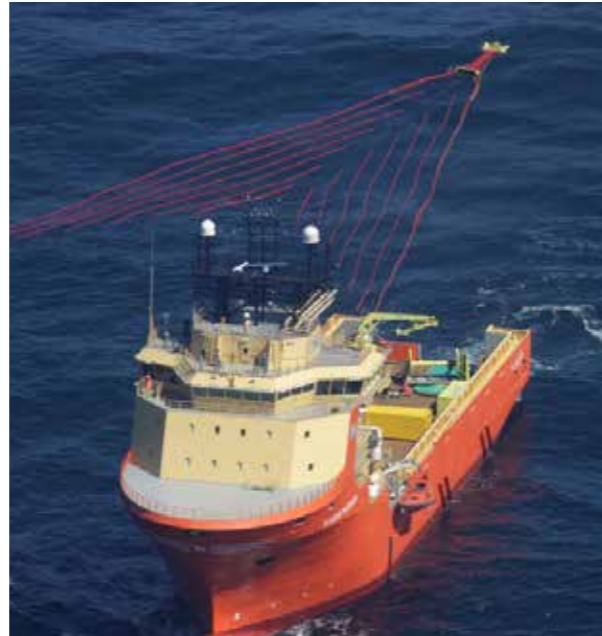
MOS Sweeper er en ny generasjon havgående oppsamlingsystem utviklet i Norge.
