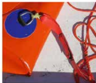
Fig. 2.3 A Hekkbrettforhindringstau med borelås fester
