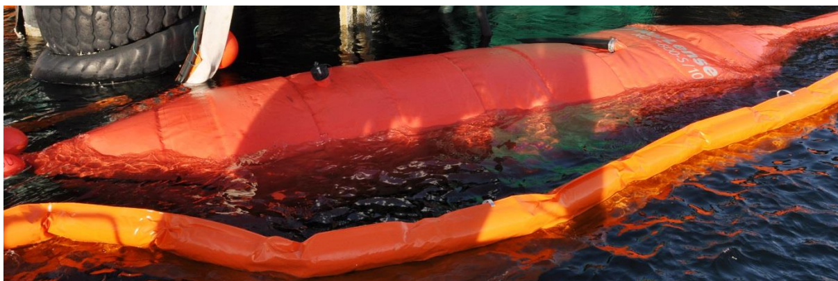
Oppsamlingspose fylt med 80% av lagringskapasitet med emulsjon.
