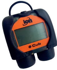
Gassmåler som umiddelbart gir signal ved for høy avdampning av flyktige organiske forbindelser.
