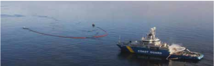
Lensesystem med «åpen-U» slepes foran fartøy med mekaniske fangarmer.
