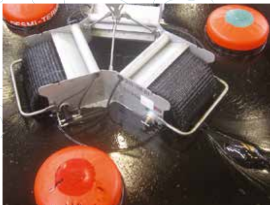
DESMI Terminator, med børstekassett, testolje 70.000cP
