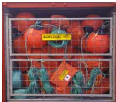
1. 100m NOFI 350 EP-lense, komplett med blåser og tauverk i pakkramme.
