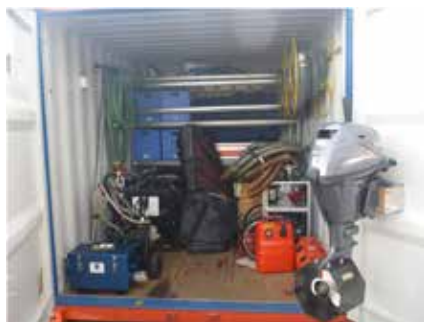
4. FoxTail 1-6 oljeopptaker med aggregat, lamor LIP sugepumpe med slanger, Lamor LPP 7HA diesel-hydraulisk aggregat, strømaggregat, arbeidslys, høytrykkspyler kaldtvann, spylepumpe, påhengsmotor, oppblåsbar gummibåt.
