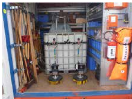
3. FoxMix roterende børste, storsekkstativ, åpne oljetanker i stativ, IBC-konteiner, diverse håndverktøy, hansker, engangsdresser, førstehjelpsutstyr, trillebår, spåder, krafser, river m.m.
