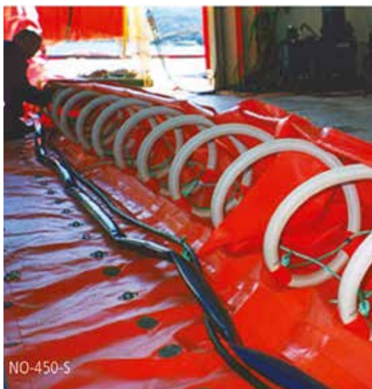
Åpen lenseduk på NO-450-S. Trykksatt spiralslange spiler ut lenseduken i overvannsdelen.
