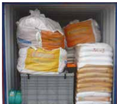
2. 100 sekker oljebark, 250m absorberende lense med/uten skjørt, tauverk. Oil Fighter, barkblåser i bæremeis.
