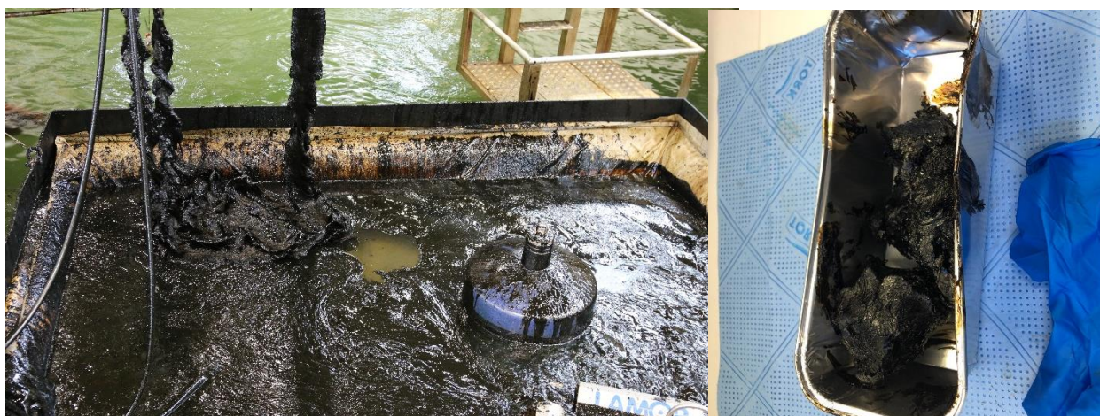
Figur 5-17 ULSFO og båndskimmer og illustrasjon av manglende tilflyt av olje. Hullet i oljen fylt med vann der skimmeren var plassert tidligere «lukker» seg ikke med olje på grunn av manglende tilflyt. Boks med stivnet olje i romtemperatur.
