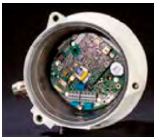
Overvåkning modul er integrert i objektene fra fabrikk.
