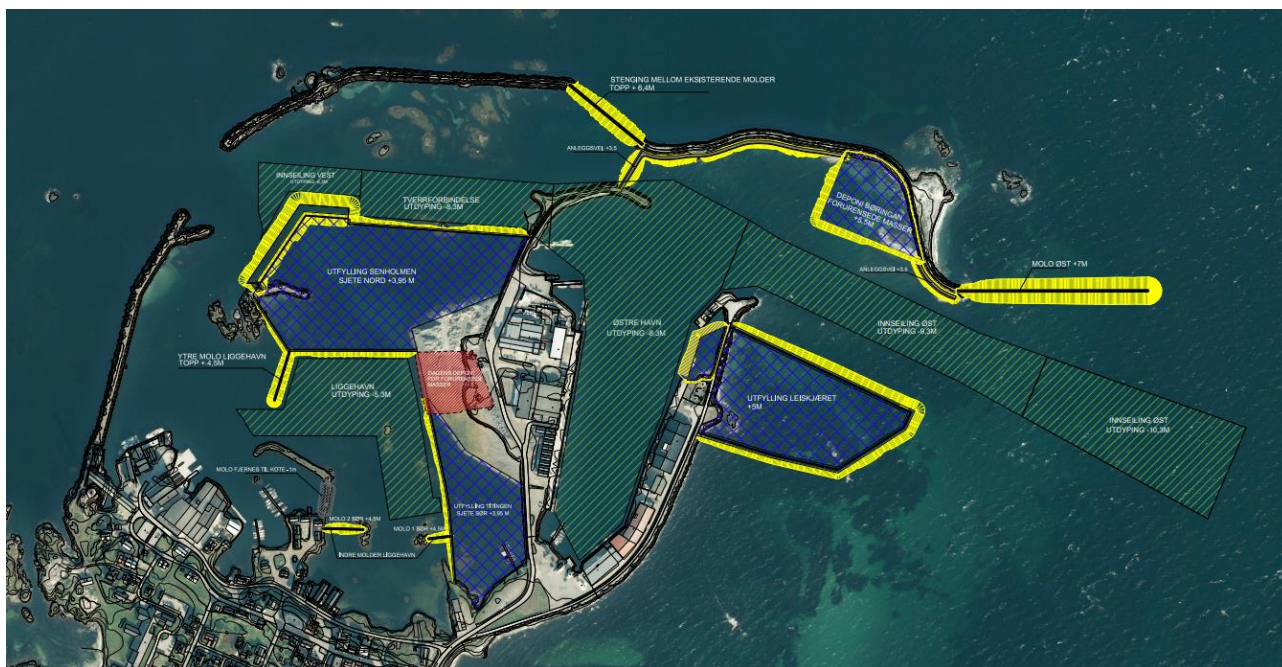
Figur 1 Oversiktsbilde av de planlagte tiltakene og delområdene. Utdypingsområdene er merket med grønn skravur, mens utfyllingsområdene er merket med gul og blå.
