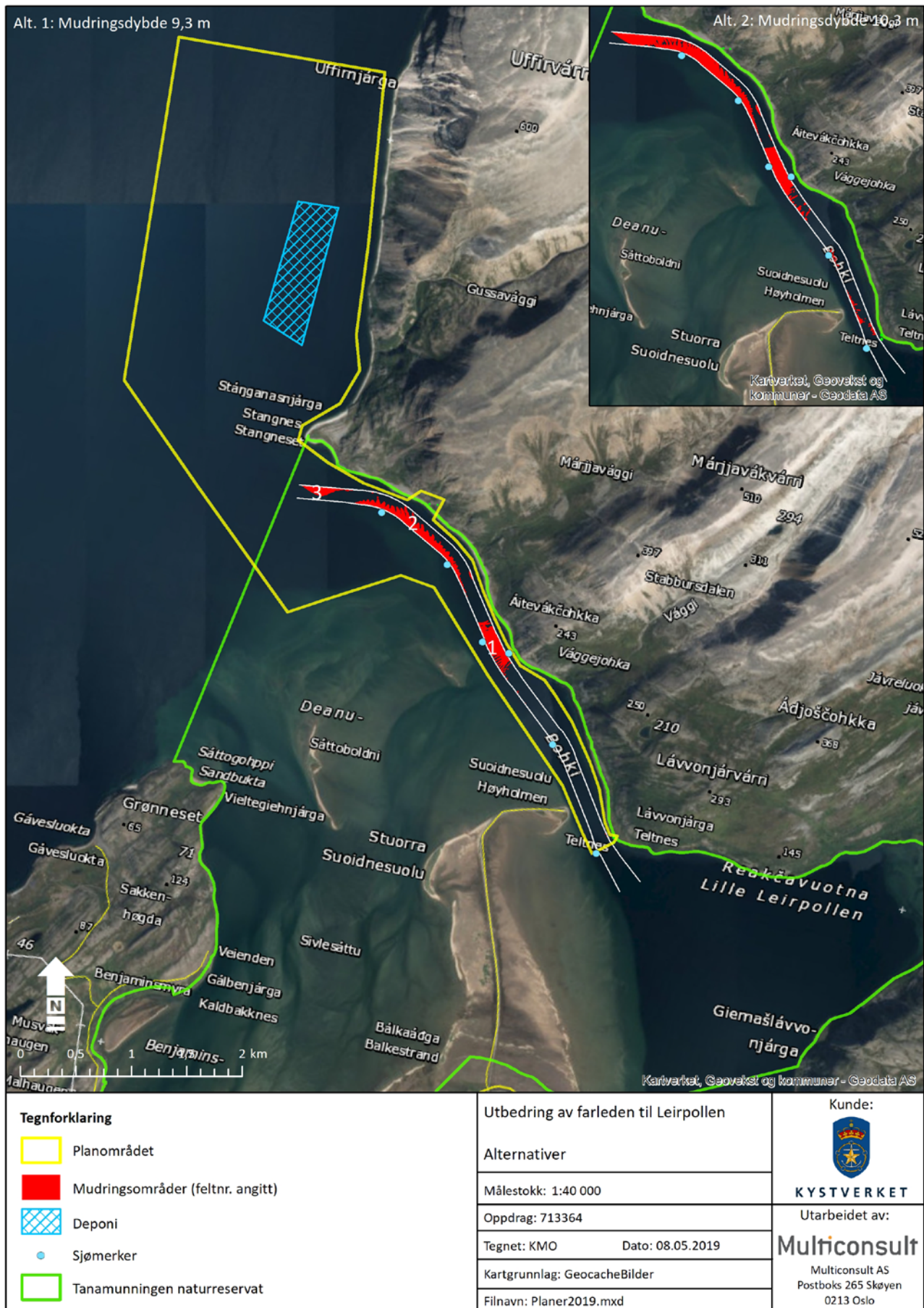
Figur 4-1. Oversikt over planområdet, mudringsområder og -alternativer, deponiområdet utenfor Stangnes, nye sjømerker samt Tanamunningen naturreservat. Kilde: Kystverket
