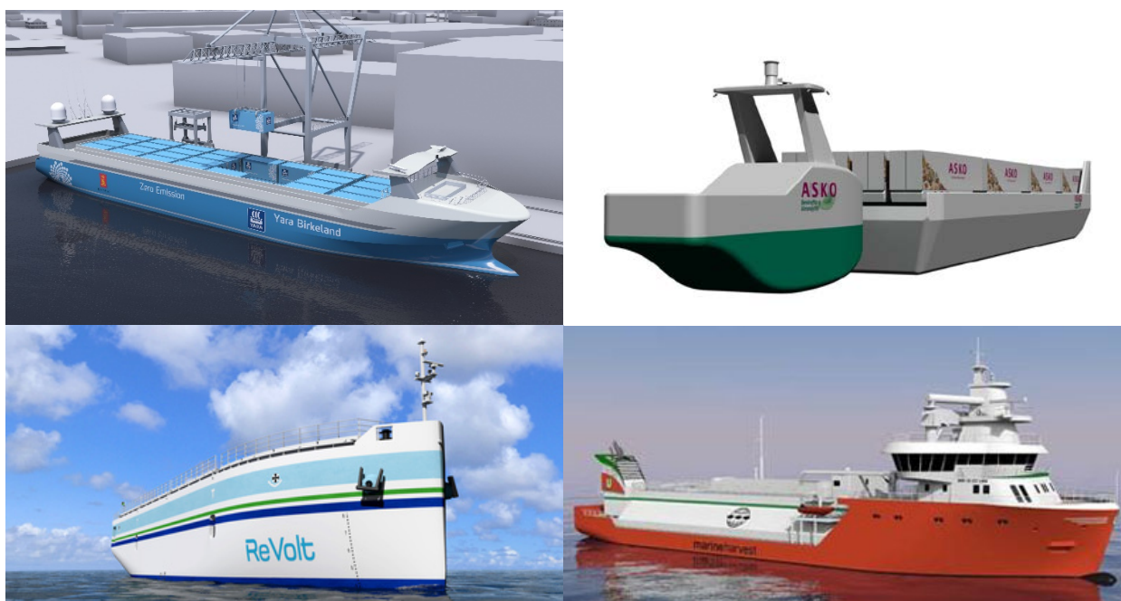
Figur 7-3: 1. Yara Birkeland, 2. ASKO elektrisk og autonom kryssing av Oslofjorden, 3. Autonom batteridrevet kystfeeder med bakgrunn i DNV GLs konseptskip ReVolt, 4. Hybrid havbruksbåt på LNG/batteri
