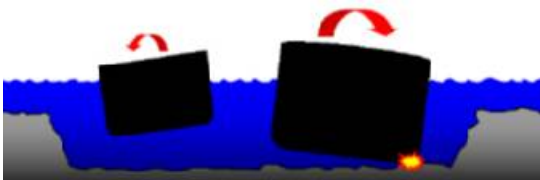
Figur 5 Transversal squateffekt mellom to fartøy som passerer hverandre
