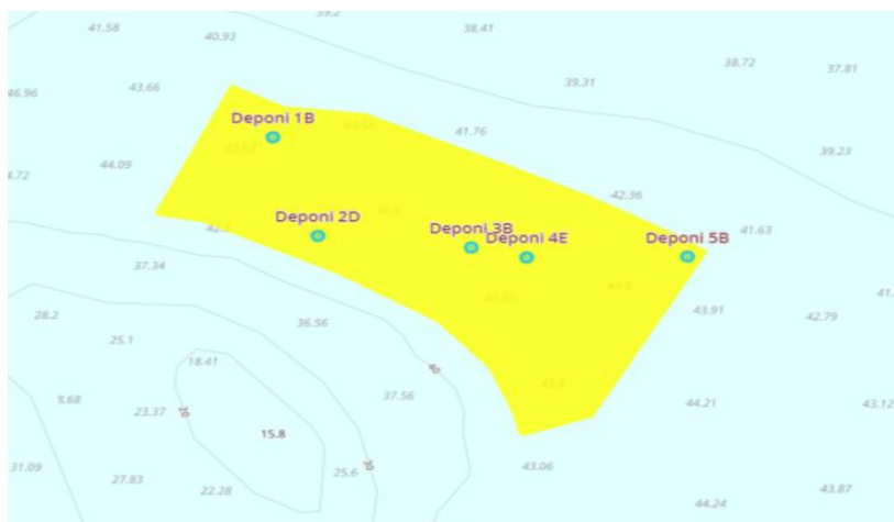
Figur 5. Midtpunkt for sedimentprøvestasjoner (lyseblå ringer) som ble tatt i det planlagte deponiområdet (markert i gult). Det ble tatt fire delprøver ved hver stasjon, som ble samlet sammen i en blandprøve.
