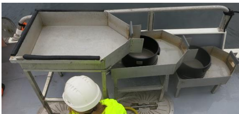
Figur 11. Sediment i godkjente prøver ble skylt med vann og siktet på et vaskebord, gjennom sikter med 5 mm og 1 mm hull.
