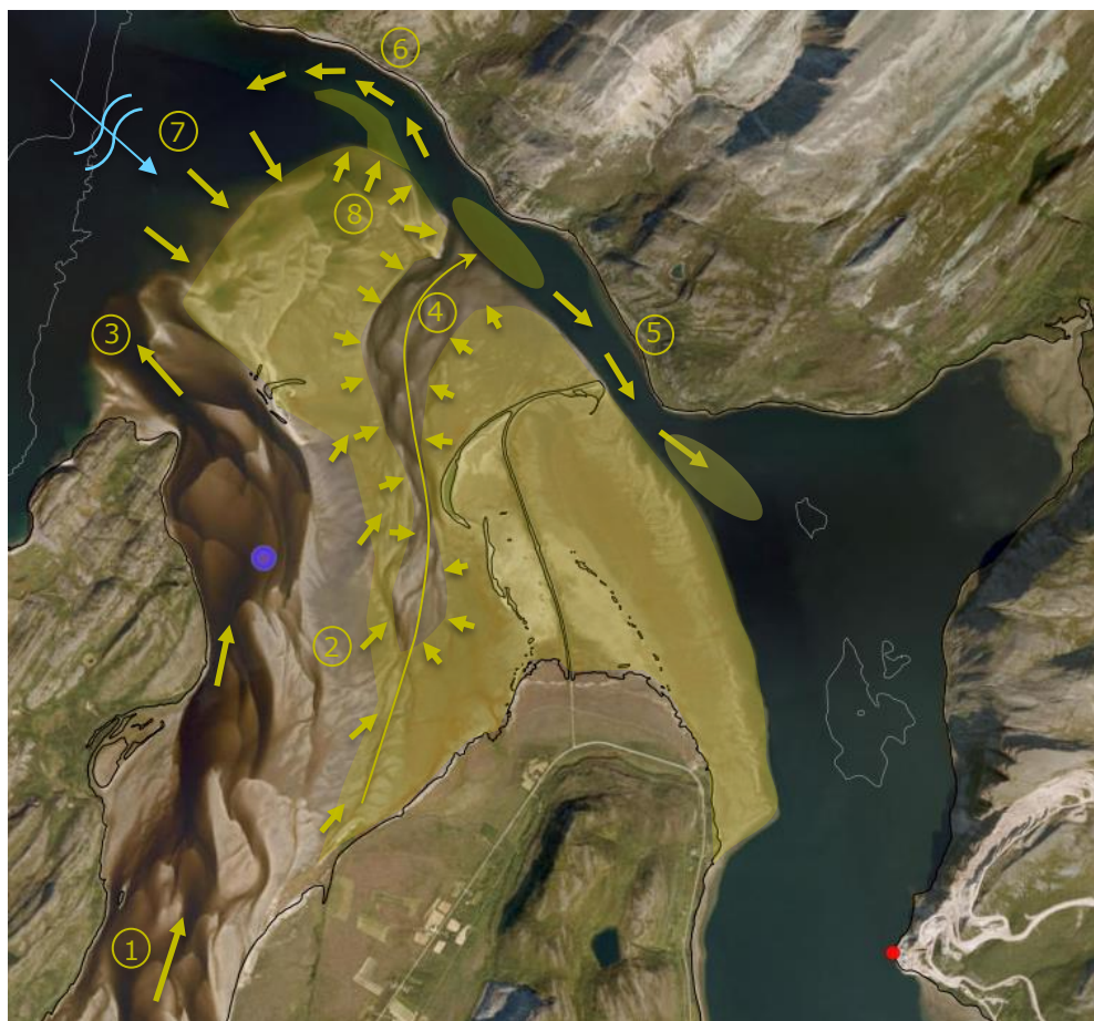
> Figur 18 Kvalitativ skisse for sedimenttransport i Leirpollen. De gule pilene viser retning for sedimenttransport (gjennomsnittlig), de fargede områdene viser deponeringsdominerte områder og den blå pila viser bølger og vind fra fjorden.
