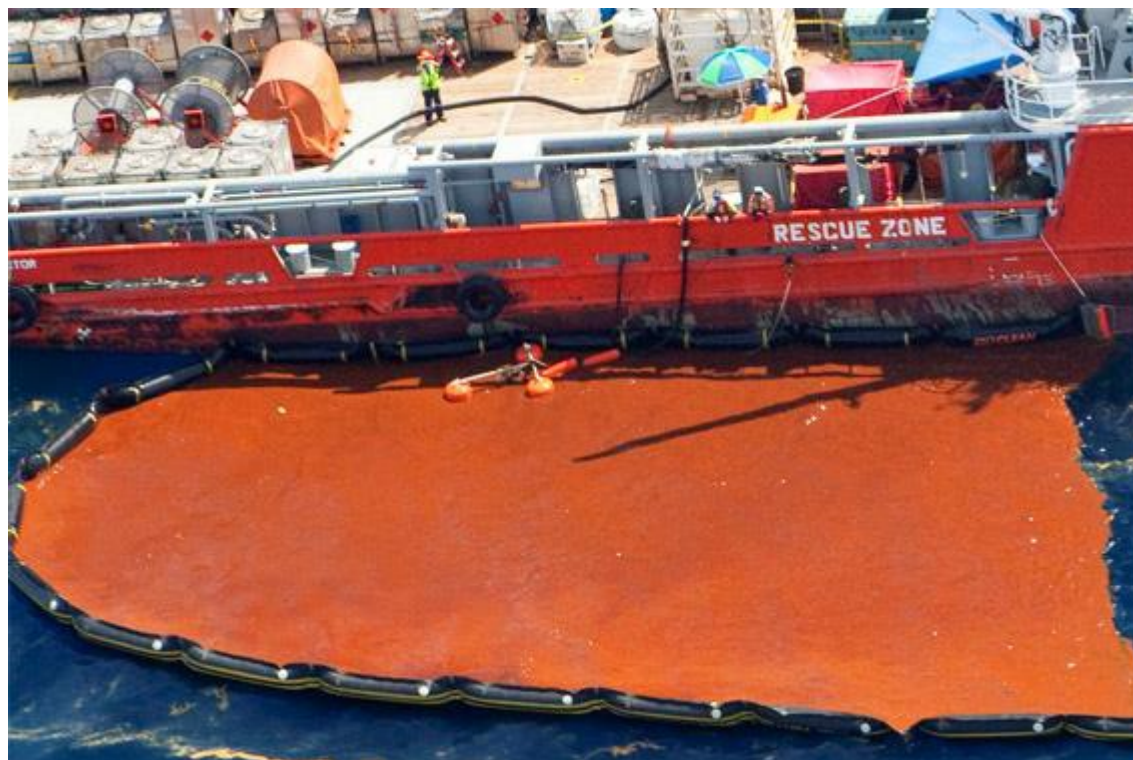
Figur 4-13 Rust-farget emulsjon innsamlet i en lense klar for opptak med oljeopptakert. Foto: AMSA.
