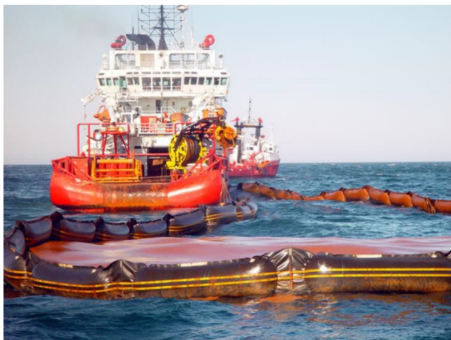
Figur 4-19 Emulsjon innsamlet i en lense klar for opptak av Transrec-systemet ombord på «Skandi Stord.»
