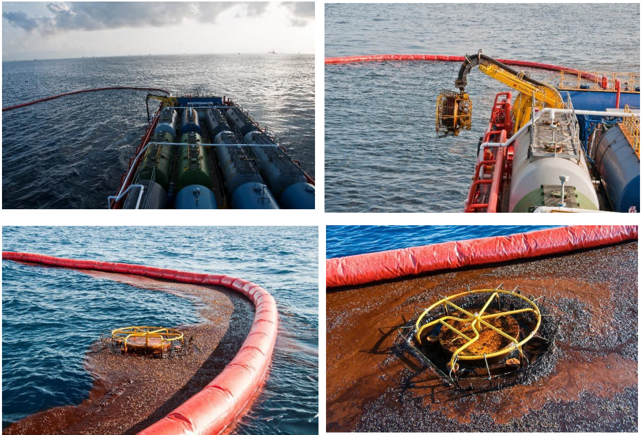
Figur 4-11 Topp: No-800 ble operert i en "J-konfigurasjon" fra Ella G. Bunn: "Hønsenetting" montert rundt optakeren for å forbedre tilflyt av emulsjonen inn i overløpet.
