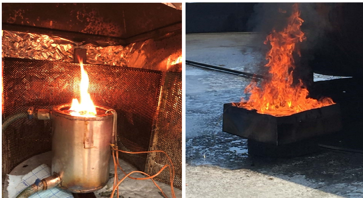
Figur 4.1 SINTEF's brennecelle til venstre og brennekar brukt på Nutec til høyre.
