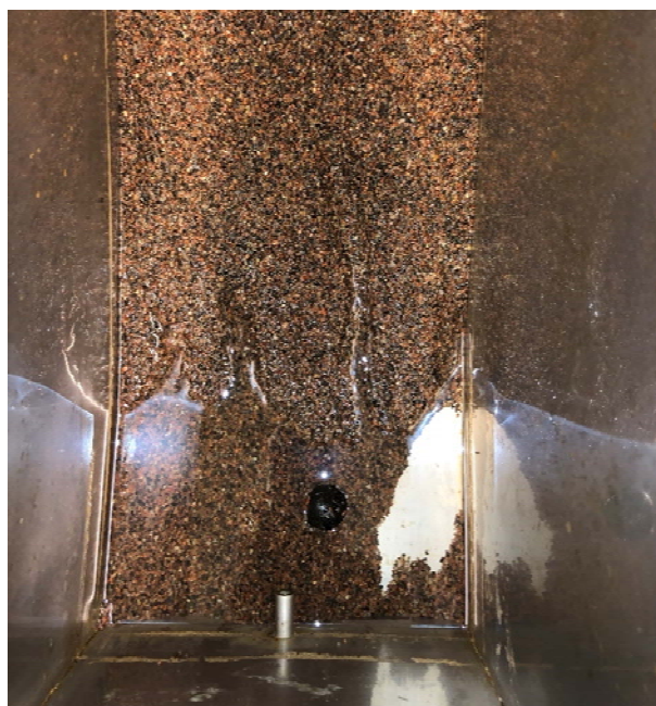
Figur 4.4 ULSFO residue eksponert i 5 timer: Kar 4A (fin sand) til venstre og Kar 10A (grov sand) til høyre.
