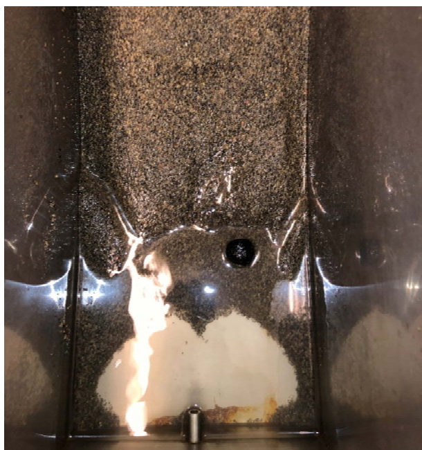
Figur 4.4 ULSFO residue eksponert i 5 timer: Kar 4A (fin sand) til venstre og Kar 10A (grov sand) til høyre.
