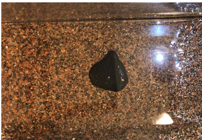
Figur 4.3 IF180 residue (kar 7A) som har sunket i en av forsøkene med grov sand (etter 2 timer).
