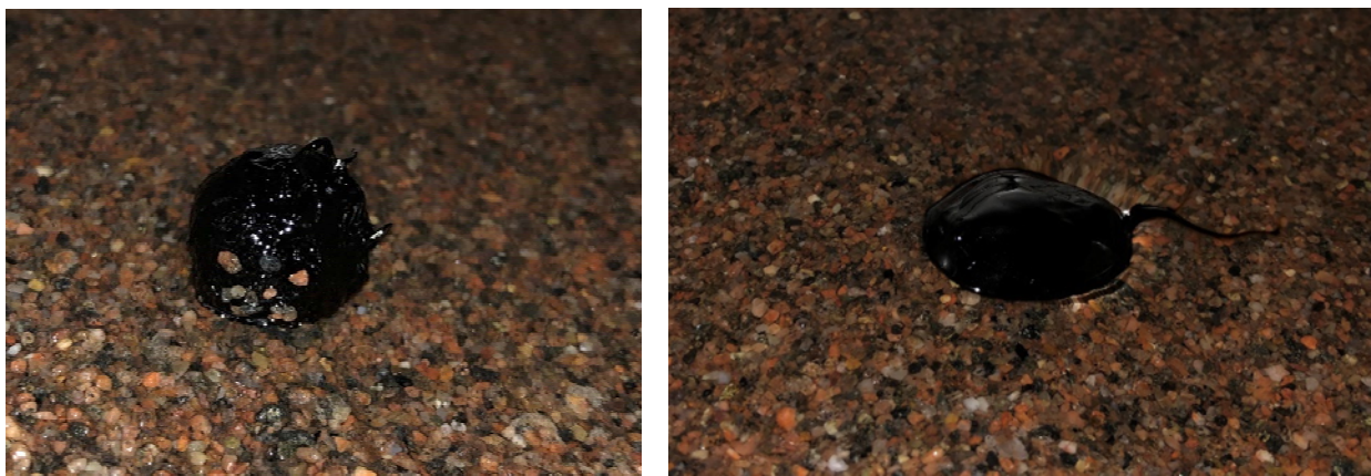
Figur 4.1 Brenneresiduer ved påføring. ULSFO til venstre (kar 12C), IF180 til høyre (kar 8B).
