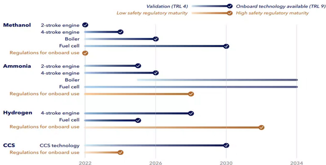
Figur 7-7 Oversikt over alternative drivstoffs egnethet og modenhet for ulike fremdriftssystemer (DNV, 2022a).
