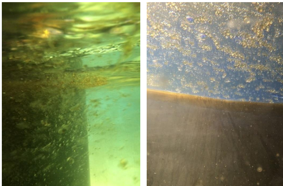
Figur 1-2: Viser nedblanding av WRG under energiinnstilling Lav II til venstre (ved sving nær bølgegenerator) og undersiden av dieselfilmen på langsiden. Dråper som har blitt blandet ned, men steget til overflaten igjen danner en perleformasjon under overflaten.
