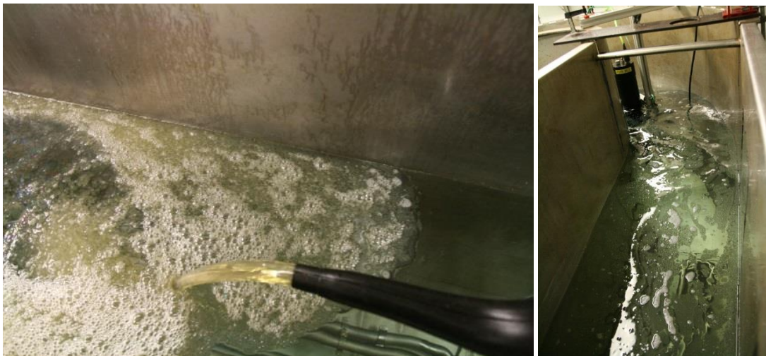
P0: Påføring av diesel med kanne og diesel på vann rett etter påføring
