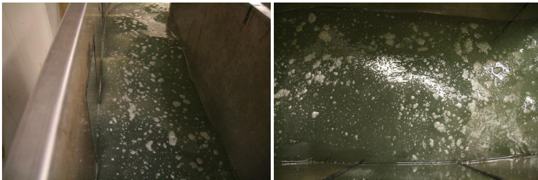
P1, 30 minutt: Skumdannelse. Oljen er klar og ligger jevnt fordelt på overflaten.
