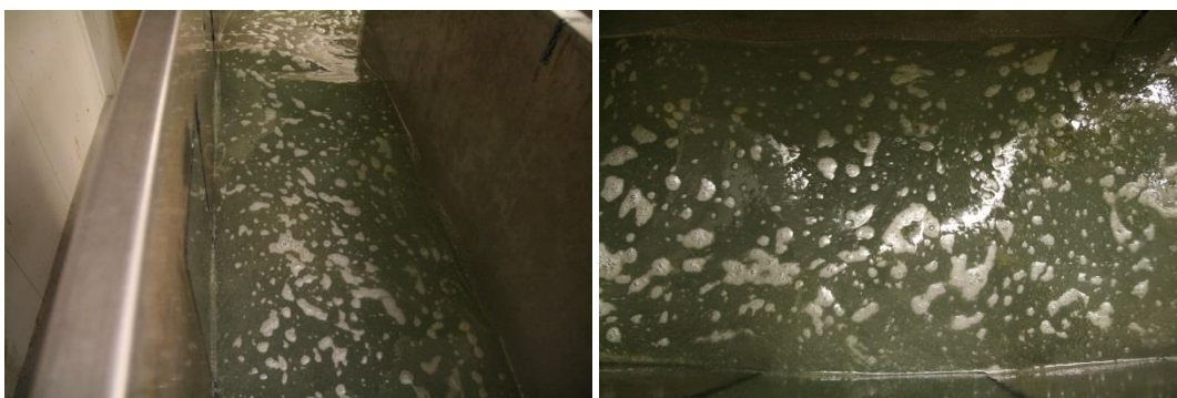
P5, 6 timer: Relativt små endringer de første timene. Det dannes mer skum og det ser ut som mer av oljen blandes ned i vannet.
