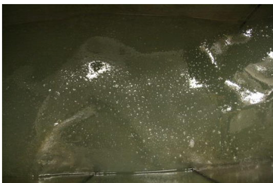
P7, 48 timer: lite olje igjen på overflaten. Oljen ligger som "perler" på vannflaten. Når den samles opp har "emulsjonen" mer slimete konsistens. Brutt emulsjon (henstand på benk) er brun/gul i farge og helt vannfri.
