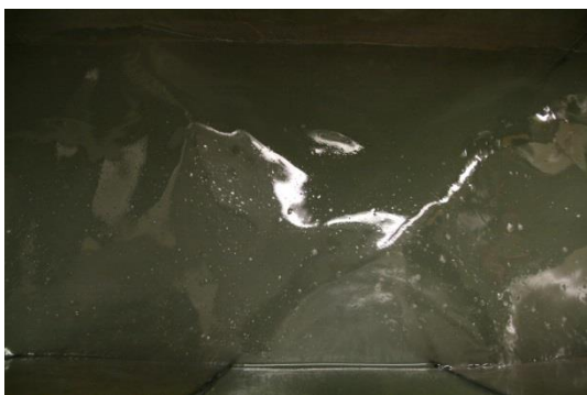
P8, 72 timer: Veldig lite olje igjen på overflaten. Bildet av skilletrakten viser emulsjonen før den bryter.
