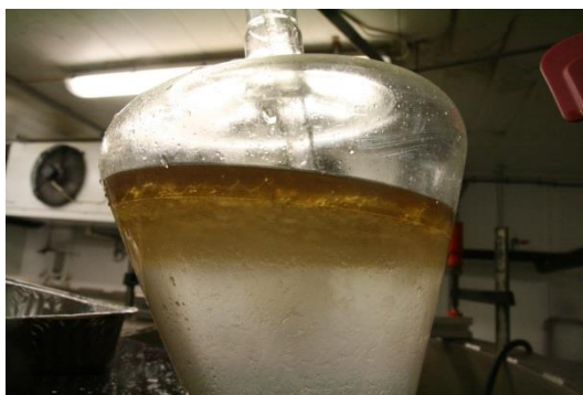
P7, 48 timer: lite olje igjen på overflaten. Oljen ligger som "perler" på vannflaten. Når den samles opp har "emulsjonen" mer slimete konsistens. Brutt emulsjon (henstand på benk) er brun/gul i farge og helt vannfri.
