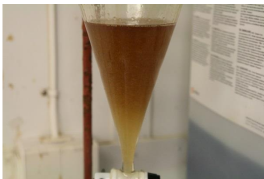
P8, 72 timer: Veldig lite olje igjen på overflaten. Bildet av skilletrakten viser emulsjonen før den bryter.
