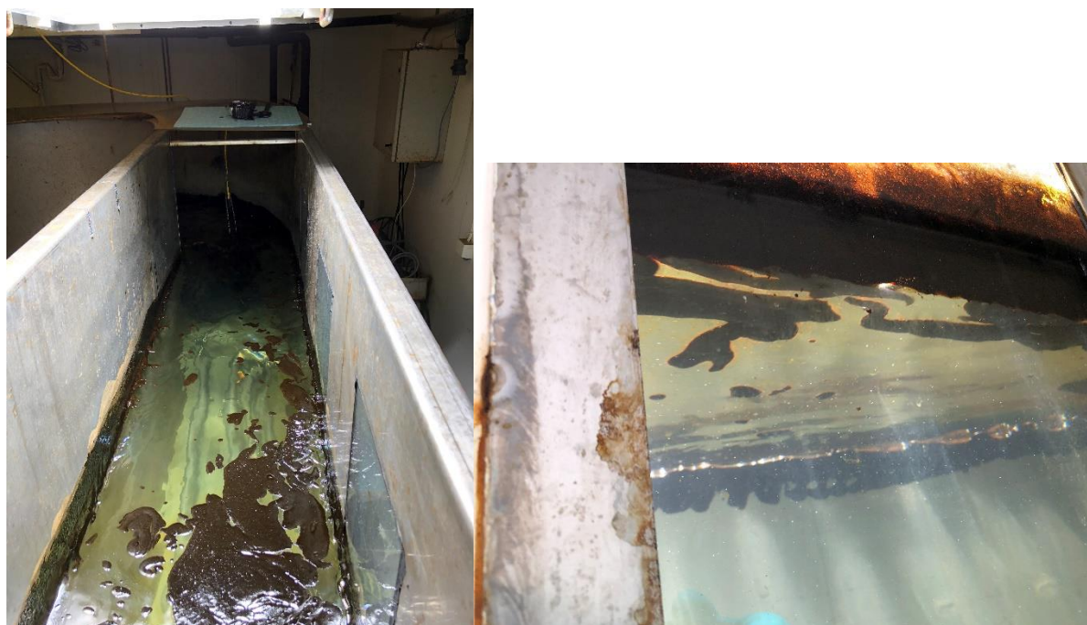
Figur 7-33 Etter 2 timer hadde emulsjon oppnådd en viskositet på 18 068 mPa.s. Emulsjonen holder seg på overflaten og det er lite olje nedblandet i vannmassen
