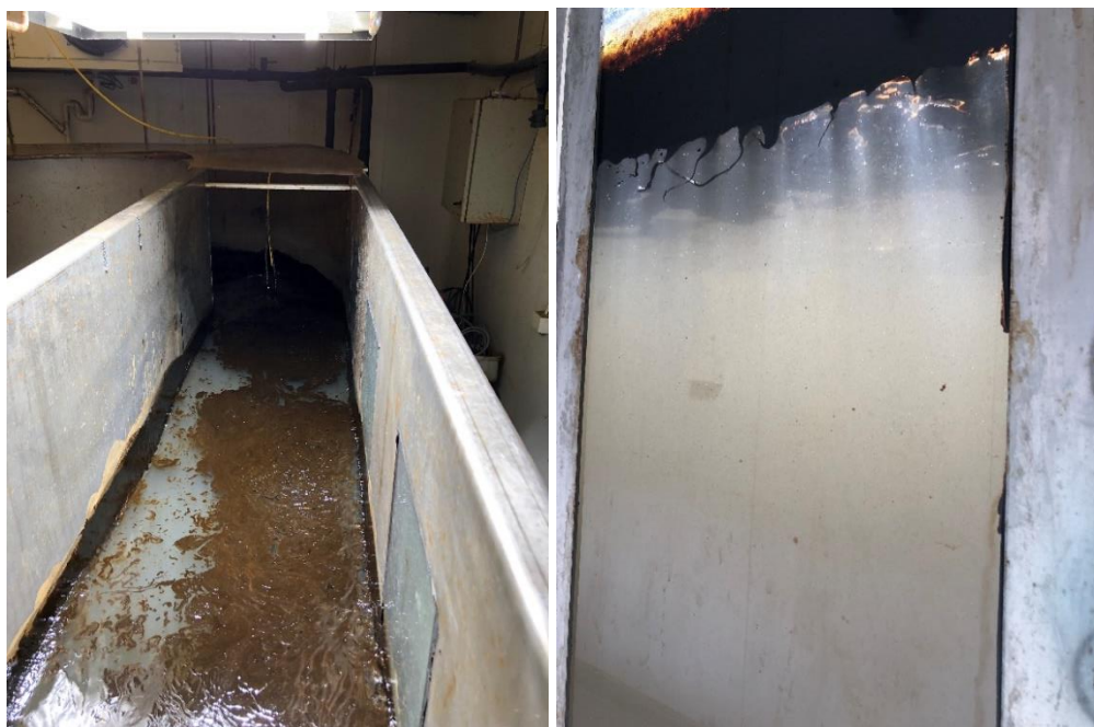
Figur 7-37 60 min. etter første dispergering med Corexit 9500 (viskositet 18482 mPa.s, 40 % vannopptak). Oljedråper nedblandet i vannmassen ser nå litt mindre ut, men fortsatt store tråder
