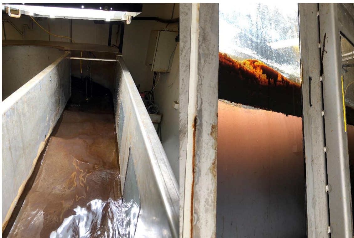
Figur 7-26 10 minutter etter 3. dispergering er det tilsynelatende veldig lite olje igjen på overflaten (kun et tynt lag). < 0,5 liter. Venstre: Bølgeenergi Høyre: Ingen oljelag observert på overflater når vi ser fra siden. Oljen som er nedblandet har fått mindre dråper – ikke like mye tråder enn det som ble observert etter de foregående rundene dispergering, og denne dispersjonen vil være langt mer stabil enn de foregående
