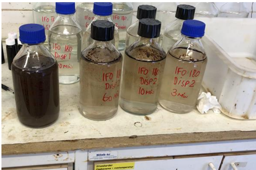
Figur 7-27 Fra venstre: Vannprøver 3 min. etter 3. gangspåføring, 2. gangspåføring (60, 10 og 3 min). Bakke rekke: Vannprøver etter 1. gangspåføring
