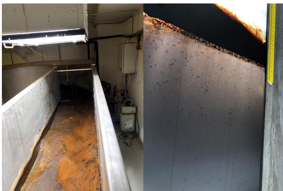
Figur 7-24 60 minutter etter dispergering har oljens utseende endret seg og observerer store dråper og tråder i vannfasen
