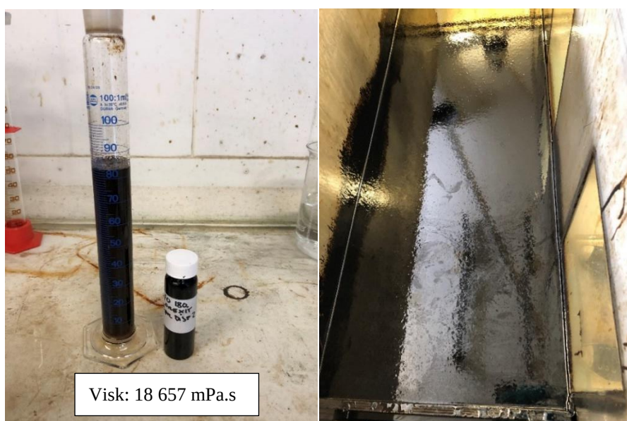
Figur 7-38 FET-test på oppsamlet olje før andre dispergering viser at oljen kan ansees som godt dispergerbar (venstre). Til høyre ser vi oljen som er samlet opp før andre runde dispergering
