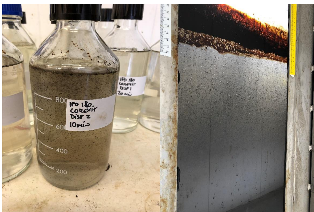
Figur 7-40 Vannprøve 10 min. etter 2. dispergering med Corexit 9500
