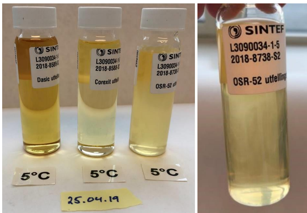
Figur 8-3 Venstre (5 °C etter endt utfellingstest): Dasic NS og Corexit 9500 tilbake til normal framtoning og konsistens. Ingen bunnfall. OSR-52: Tykkflytende, blakket og kornete konsistens (ingen bunnfall). Høyre (romtemperatur etter endt utfellingstest): Observerv suspendert materiale for OSR-52
