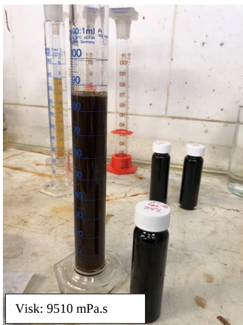
Figur 7-25 FET-test på før tredje dispergering viser at oljen er godt dispergerbar
