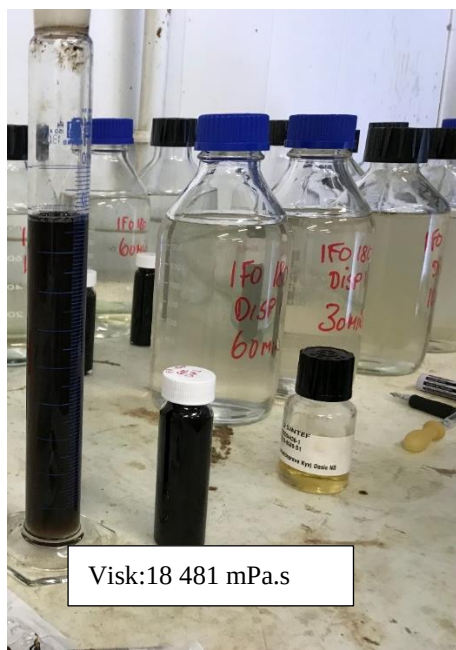
Figur 7-22 FET-test på oppsamlet olje før 2. dispergering av Dasic NS. Olje/emulsjon er godt dispergerbar
