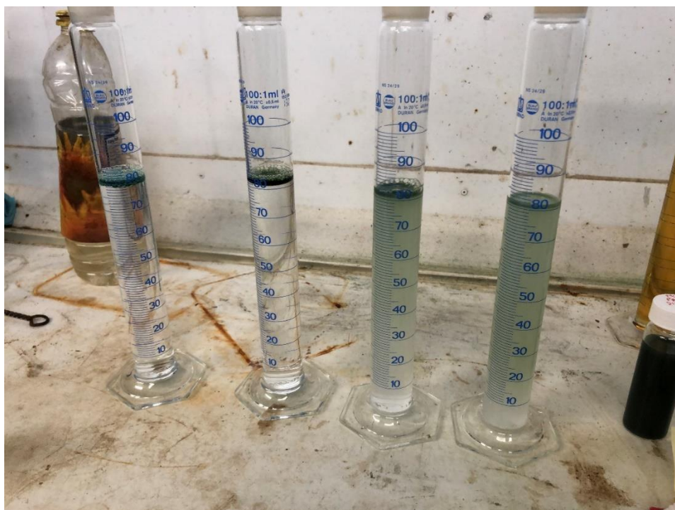
Figur 7-9 FET-test etter første dispergeringsrunde. Fra venstre mot høyre: Utgangsoljen (fersk), forvitret overflateolje etter 20 timer, prøve tatt før andre runde dispergering og prøve tatt før andre runde dispergering med ekstra tilsats av dispergeringsmiddel. Oljen danner ikke dispersjon uten dispergeringsmiddel. Ekstra tilsats (andre runde dispergering) har positiv effekt og gi en mer fullstendig dispersjon
