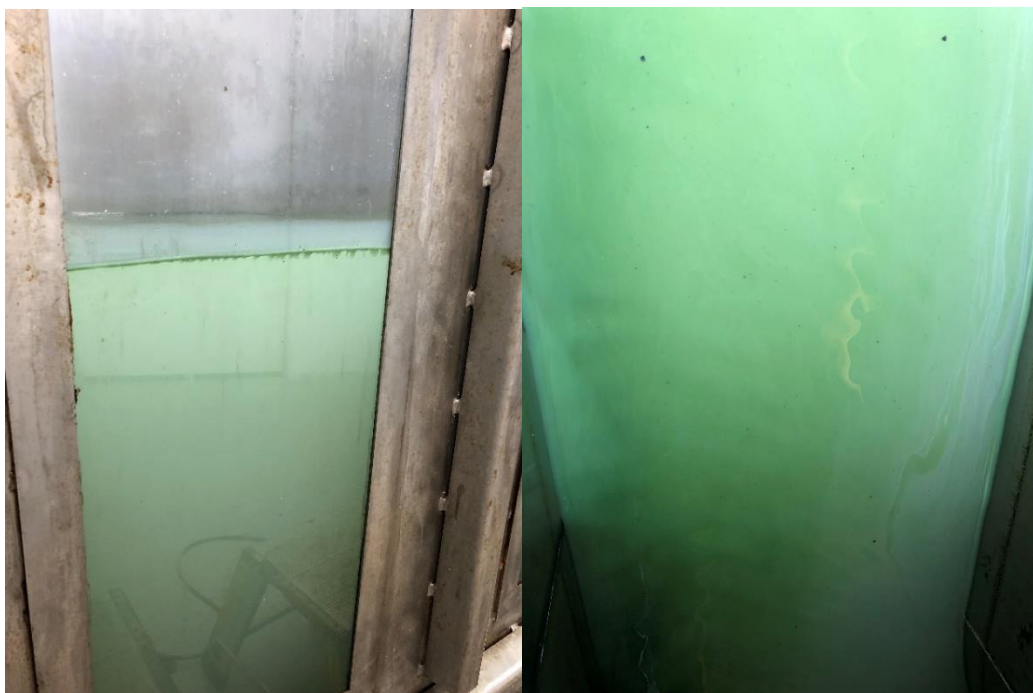
Figur 7-10 10 min. etter andre dispergering med Dasic NS ble det observert betraktelig mindre olje på overflaten enn etter første runden med dispergering
