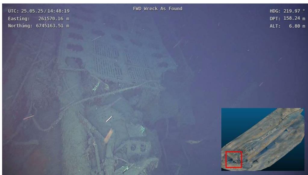
Figur 18 Bilde fra HD-video fra bruddpunktet i baugseksjonen
