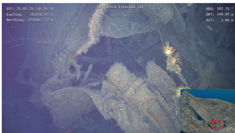
Figur 17 Bilde fra HD-video fra bruddpunktet i akterseksjonen
