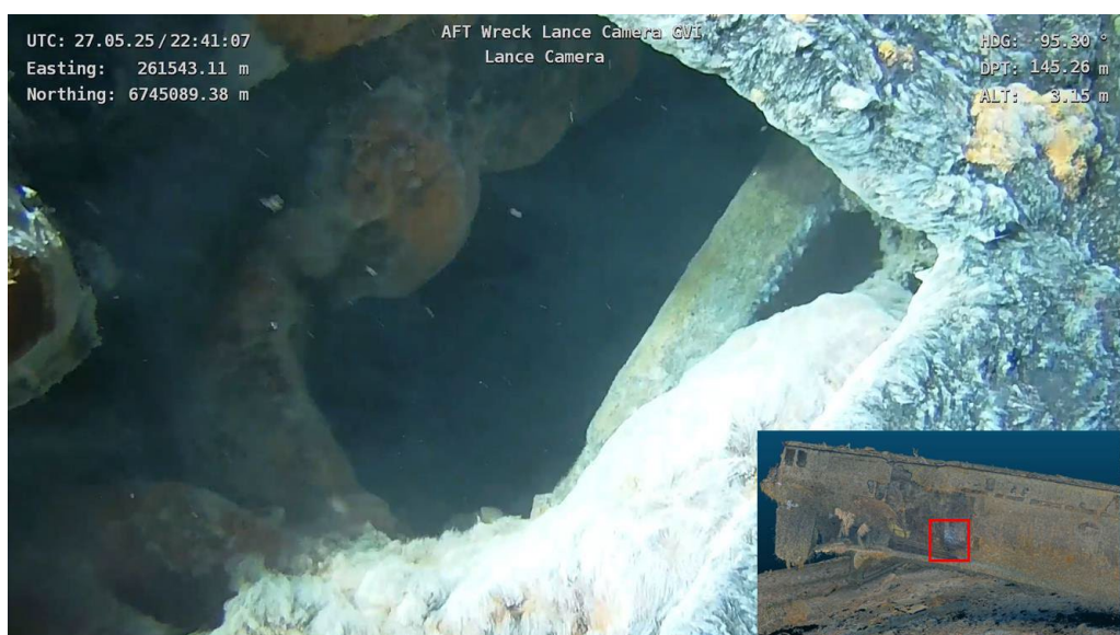
Figur 19 Eksempel fra lensekamera før innføring i skroget ved torpedorommet i akterseksjonen
