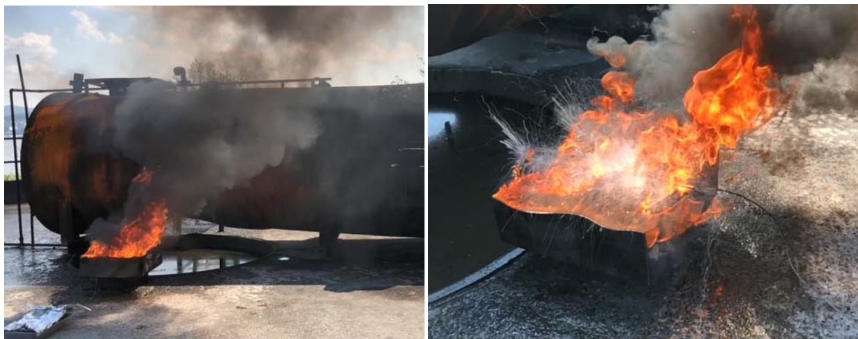
Figur 3.2 ISB av ULSFO. Bildet til høyre viser støtkokingen.
