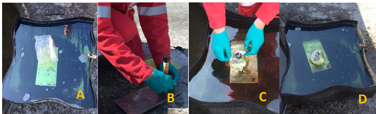
Figur 2.1 Gel posisjonert på en metallpinne midt i karet (foto A). Oppsett av nødbluss med gel er vist i de neste bildene: Nødblusset ble festet til metallpinnen (foto B), og gel-posen ble tapet rundt nødblusset før det ble plassert i karet (foto C og D). Termoelementene er festet på høyre side av karet.
