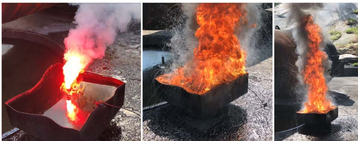
Figur 3.3 ISB av IFO 180. Bildet til venstre viser antennelse av flare (nødbluss) med gel. De øvrige to bildene viser brenning av IFO 180 antent med gel.
