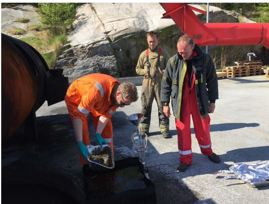
Figur 2.3 Oppsamling av residue etter brenning av MGO.
