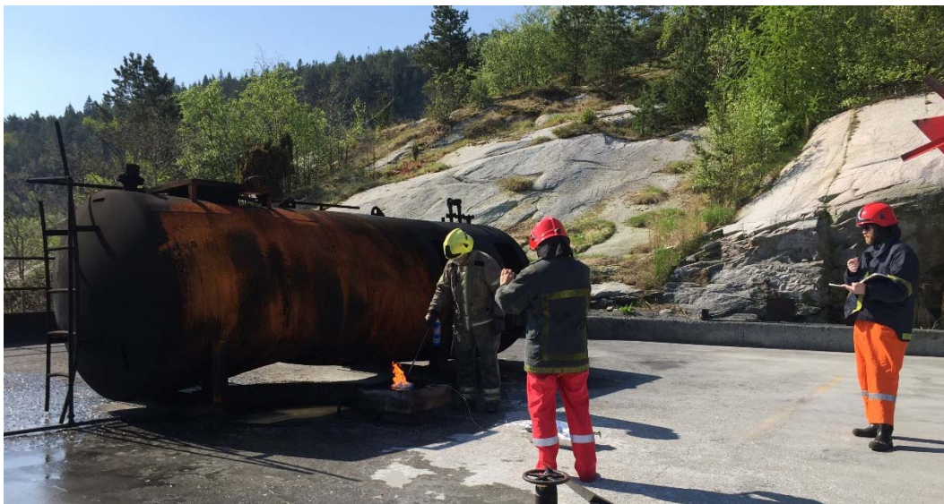
Figur 2.2 ISB av MGO: Gel-posen er nettopp antent med gass-flamme.
