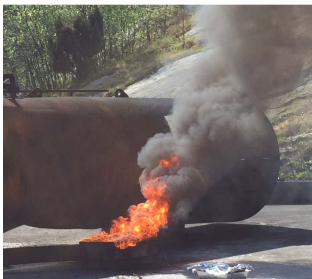
Figur 3.1 ISB av MGO, bildet til høyre er like før flammen slukker.
