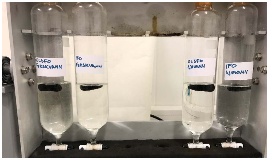
Figur 2.4 Oppsett med roterende skilletrakter for synketesting av residue etter ISB.
