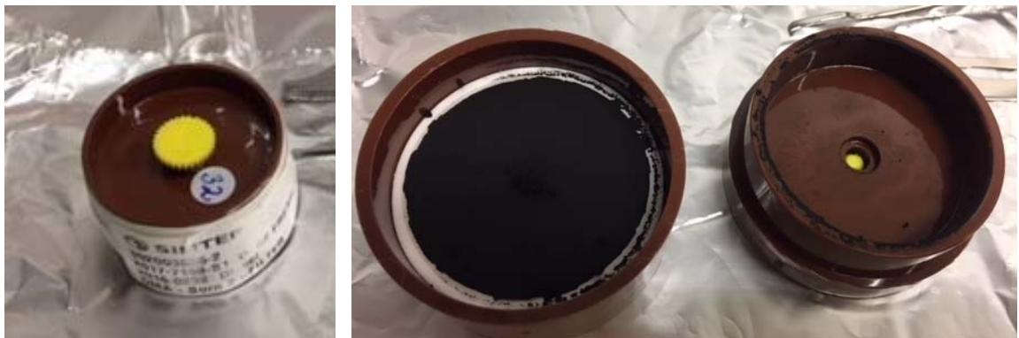
Figur 2.4 Filterkassett for prøvetakning av sot (venstre bilde) og åpnet filterkassett med sotfilter etter brenning.
