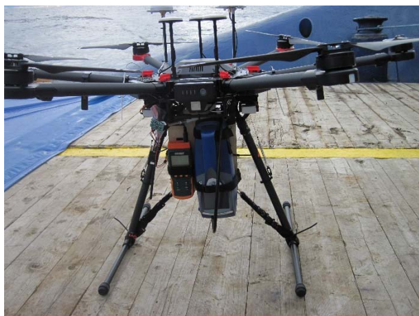
Figur 2.1 Drone 1 klar til avgang med monitoreringsutstyr for bl.a. partikkelstørrelse og røykgasser.
