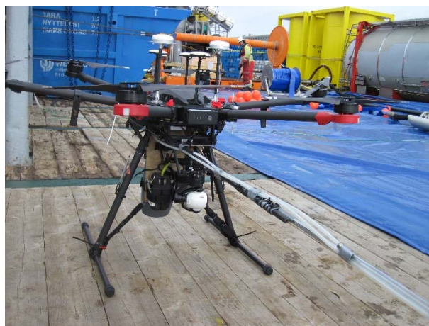
Figur 2.1 Drone 1 klar til avgang med monitoreringsutstyr for bl.a. partikkelstørrelse og røykgasser.
