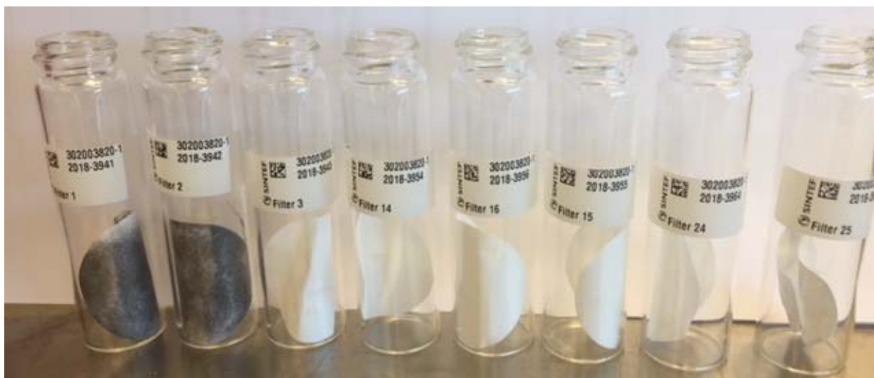
Figur 3.14 Ekstraherte filter. Filter 1 og 2 (lengst til venstre) ble brukt på Drone 1 under ISB av hhv Oseberg 200+ og ULSFO i sot-plumen nærmest brannen. Beskrivelse av filtrerne er gitt i Tabell 3.1.
