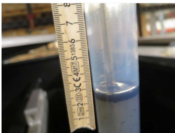
Figur 4 En fri fase prøvetaker kan brukes til å finne tykkelsen på oljefilmen på vannoverflata og dermed brukes til å estimere det totale volumet olje i karet.
