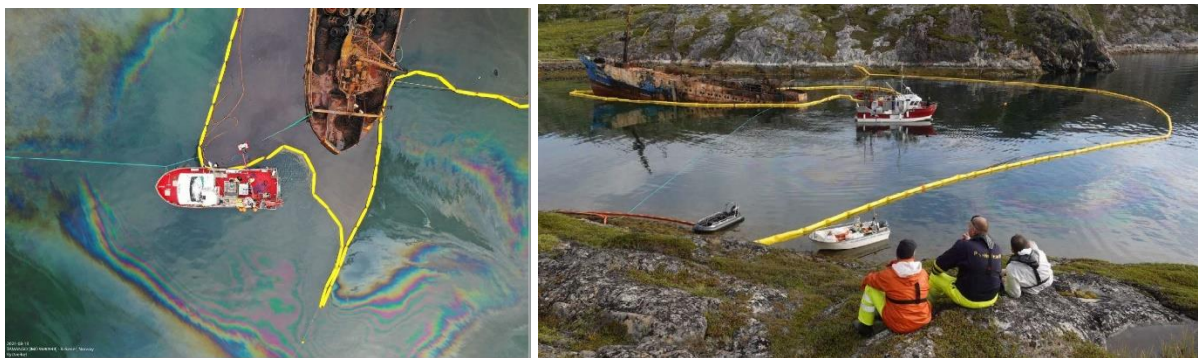
Figur 3-5 Kystverkets FKB Else-K i aksjon med Noren-skimmer. Opptak av ca. 15 m 3 diesel, smøre- og hydraulikkolje.
