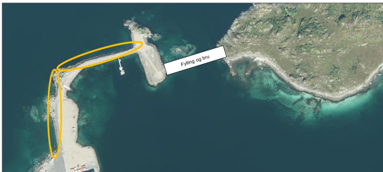
Figur 18. Sikring av fyllingsfronter og fylling med bru over til Kalvøya.
