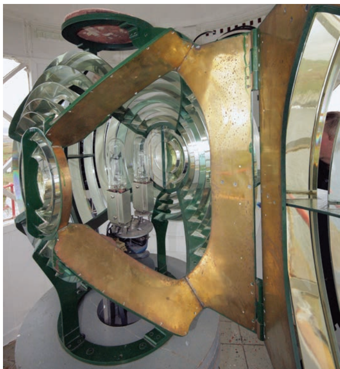
Linse, åpnet og svingt ut. Messing deler synlige.
