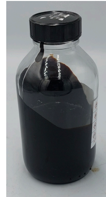
Oljeprøve: Denne oljeprøven er i likhet med om lag halparten av de innsamlede prøvene ikke flytende ved romtemperatur (Foto: CEDRE).
