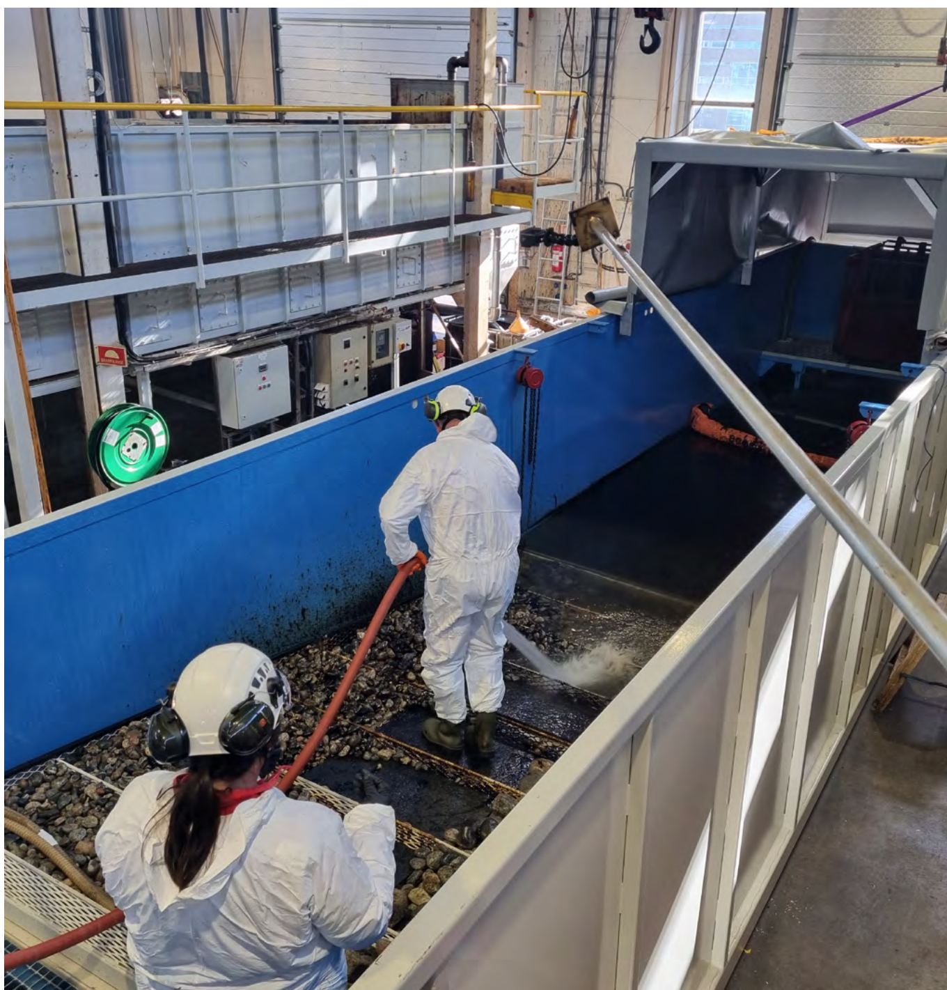
Kystverkets personell tester strandrensemetoder under kontrollerte forhold i testanlegget i Nasjonalt senter for testing av oljevernutstyr i Horten. Foto: Stig Nordaas, Kystverket
