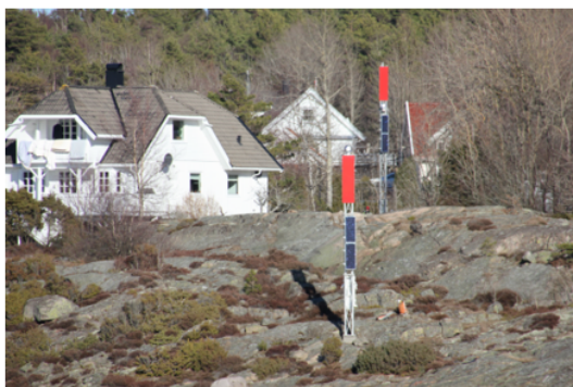
Overrett med røde rektangulære refleksplater. Observert fra fartøy litt til styrbord for senterlinjen
