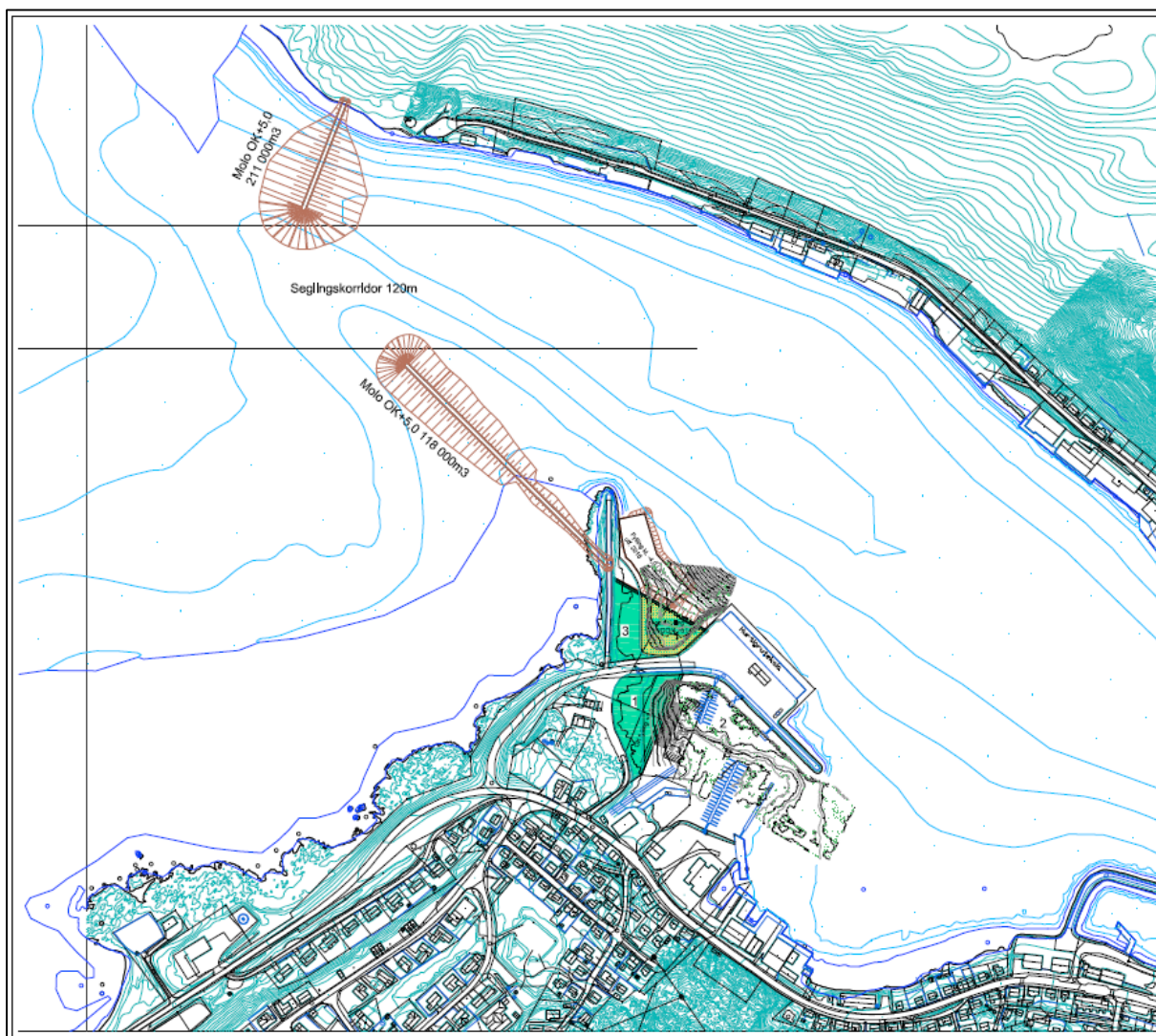
Figur 3 Alternativ P_S1, som er undersøkt i denne rapporten. Merk at den søndre moloen går ut fra den eksisterende ca 25 m fra enden av den eksisterende. Dette kartet er innmålt i koordinatsystemet Euref 35, som gir en nord-retning som er svært lik geografisk (sjøkartets) nord.
